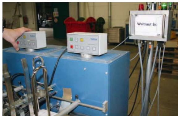
Ohne Barcode: An der Buhrs Kuvertiermaschine erfolgt der Abgleich der Adressdaten per Klarschrift, um nicht mit Barcode-Elementen arbeiten zu müssen.
