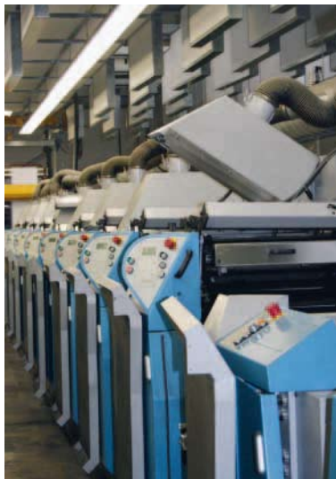
Vielfarbig: Die Offset-Endlos-UV-Mailingmaschine von Müller Martini kann bis zu zehn Farben in einem Durchgang drucken.
