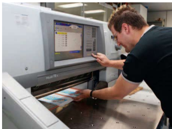
Geübter Blick: Das Beschneiden der Katalog-Umschläge am Planschneider bei Digitaldruck Deutschland.
